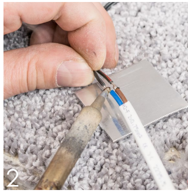
Kabel miteinander verlöten. Dabei auf Polung achten! Am besten geeignet zum verlöten sind dünne Lötspitzen. TIPP: Bei empfindlichen Bodenbelägen am besten eine Metallunterlage verwenden, so dass der Bodenbelag nicht bei den Lötarbeiten beschädigt wird.
